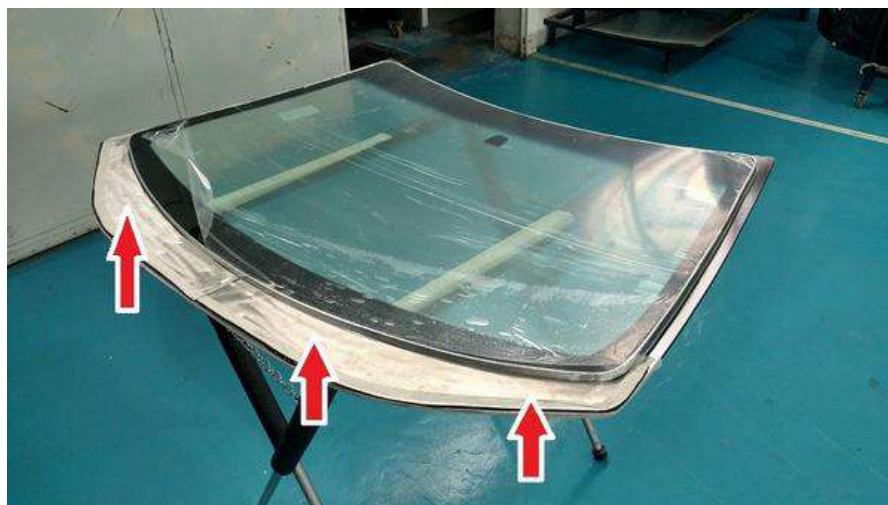
Figura 4 - Reforço em aço inox na região do offset (sorriso) do para-brisa
