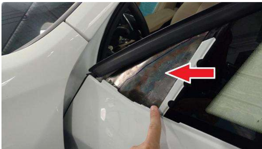
Figura 8 - Chapa de aço inox aplicada na região do retrovisor externo
