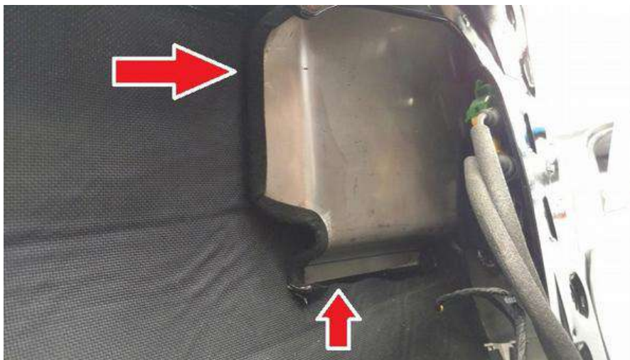
Figura 9 - Detalhe do reforço em chapa de aço inox na região da maçaneta
