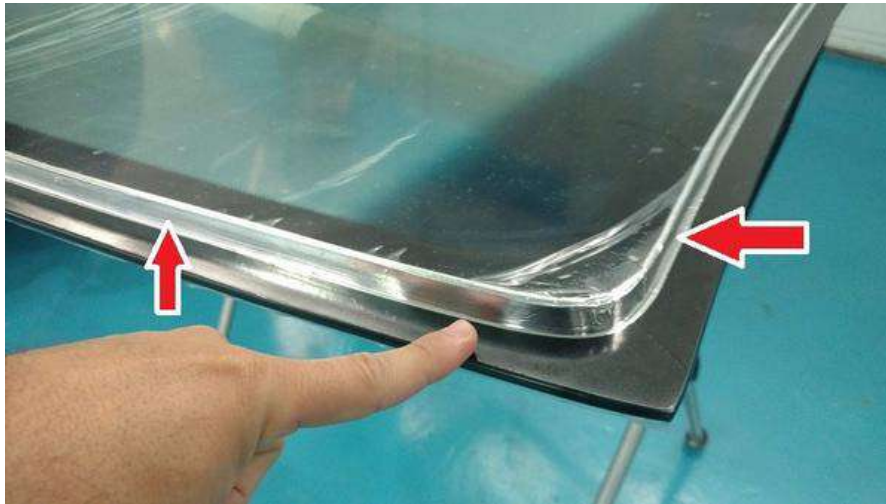
Figura 6 - Fita de alumínio aplicada à lateral do pacote de forma a evitar a contaminação das lâminas
